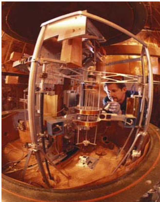
Figura 1. El físico Richard Steiner ajusta el kilogramo electrónico, un dispositivo experimental para definir a la masa en función de las propiedades fundamentales de la naturaleza. Fotografía: Copyright Robert Rathe.
