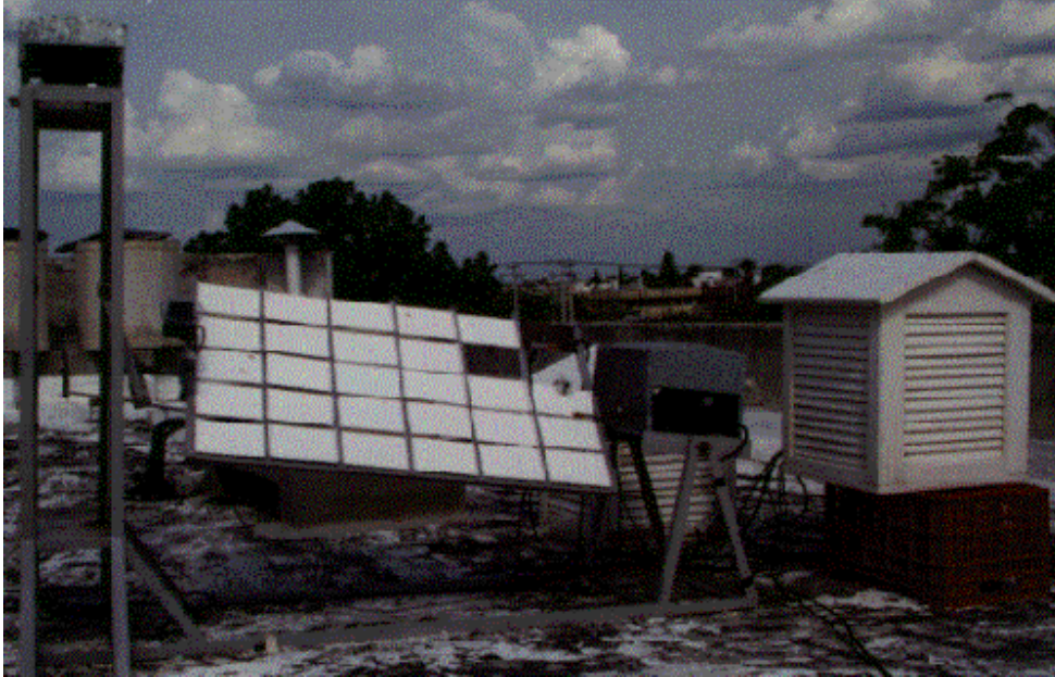
Vista general del "Panel Rotatorio" utilizado para estudio acelerado de polímeros y pinturas.
